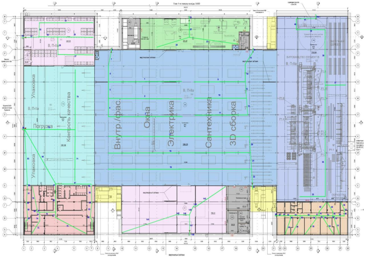
Рисунок 2.31 – Схема евакуації людей з 1-го поверху будівлі
